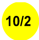
Abb. 10.3.1: Beispielhafte Beschriftung von automatischen Meldern: verdeckte Montage
